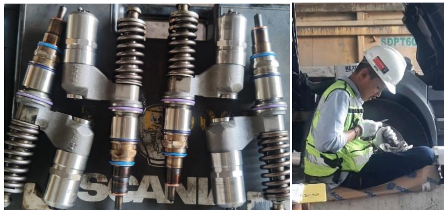
Gambar 4.77 Pelaksanaan pengerjaan Re-Oring Injector pada engine scania R580
