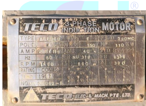
Gambar 24 Spesifikasi Motor Induksi 3 Fasa TECO di Unit Barge Loader
